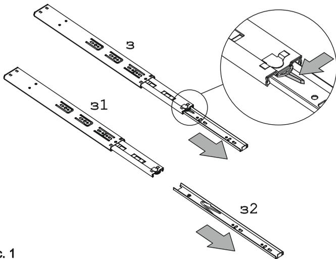
Перед началом сборки необходимо разъединить полновыкатные направляющие. Для этого максимально раздвинуть направляющую и нажать на пластиковый фиксатор. Далее выдвинуть внутреннюю часть из внешней.
